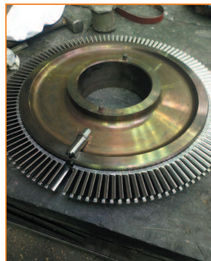
Рисунок 5. Облапачивание турбинного колеса
